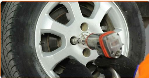
24 Baje el automóvil y, manteniendo el orden cruzado, apriete los pernos de fijación de las ruedas. Utilice una llave de impacto para llanta # 17. Utilice una llave dinamométrica. Apriételo a un par de 110 Nm.
