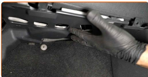
**24** Atornille las sujeciones del panel de revestimiento inferior. Utilice Torx T20.
