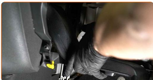
**17** Instale las sujeciones de la carcasa del conducto de aire.
