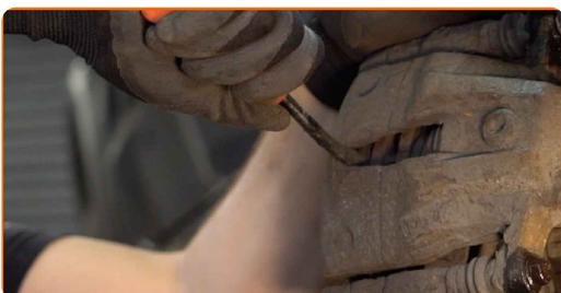
**9** Destornille la fijación del cáliper de freno. Use un vaso de impacto del n.º 12. Utilice una llave de trinquete.
