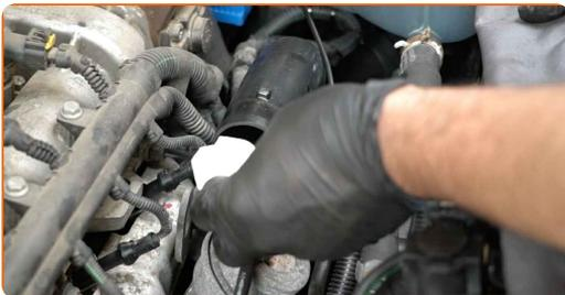
**8** Separe los conectores del cableado de las bujías de precalentamiento.
