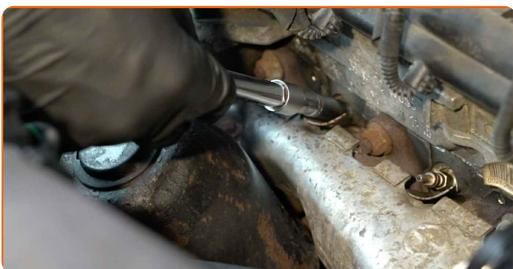
**10** Retire las bujías de precalentamiento.
