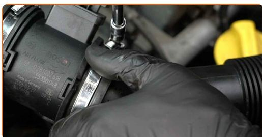
**18** Atornille la sujeción del tubo de admisión de aire. Utilice Torx T25.
