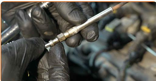
**11** Trate las bujías de precalentamiento. Utilice la grasa para inyectores y bujías de precalentamiento.
