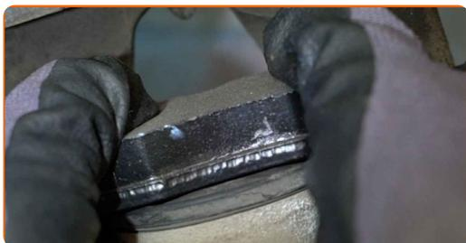
Sustitución: pastillas de freno - OPEL Corsa A CC (S83). AUTODOC recomienda:
