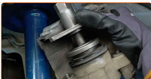
**Sustitución: pastillas de freno - OPEL Corsa A CC (S83). Consejo de AUTODOC:**
