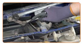
Inserte en la carcasa del filtro el nuevo elemento filtrante.
