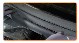
Instale y asegure la rejilla del capó. Use un vaso de impacto del n.º 8. Utilice una llave de trinquete. Utilice un destornillador Phillips.
