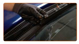
Apriete las sujeciones del brazo del limpiaparabrisas. Use un vaso de impacto del n.º 13. Utilice una llave dinamométrica. Apriételo a un par de 14 Nm.
