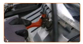
Desenrosque las sujeciones del panel de plástico. Usa una llave mixta del n.º 24.
