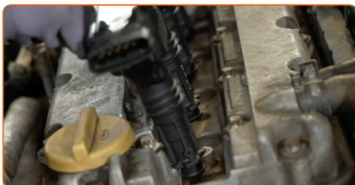
**8** Apriete los pernos de la bobina de encendido. Utilice Torx T30. Utilice una llave dinamométrica. Apriételo a un par de 7 Nm.
