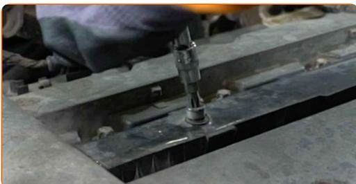
**5** Retire la bobina de encendido.
