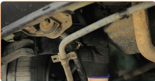
**10** Atornille las sujeciones de los soportes del cojinete del estabilizador. Use un vaso de impacto del n.º 13. Utilice una llave dinamométrica. Apriételo a un par de 20 Nm.
