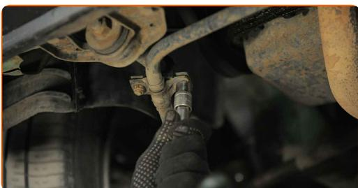
**11** Trate las sujeciones de los soportes del cojinete del estabilizador. Use grasa de cobre.
