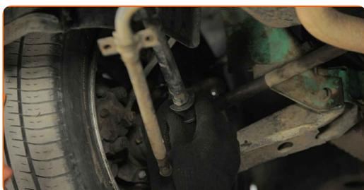
**9** Instale los soportes del cojinete del estabilizador.
