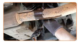
Corte la rosca para el nuevo sensor de oxígeno. Utilice un macho de roscar. Utilice una llave de trinquete.
