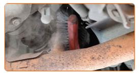
Separe el conector del sensor de oxígeno.
