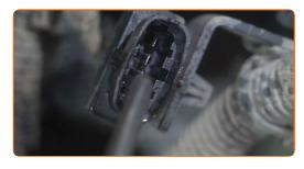
Una el conector del sensor de oxígeno.
