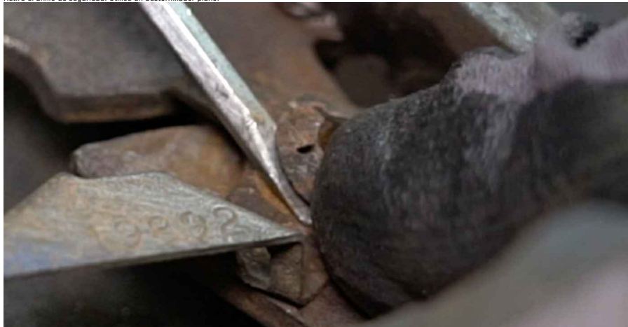
28 Retire la palanca de ajuste de la zapata de freno.
