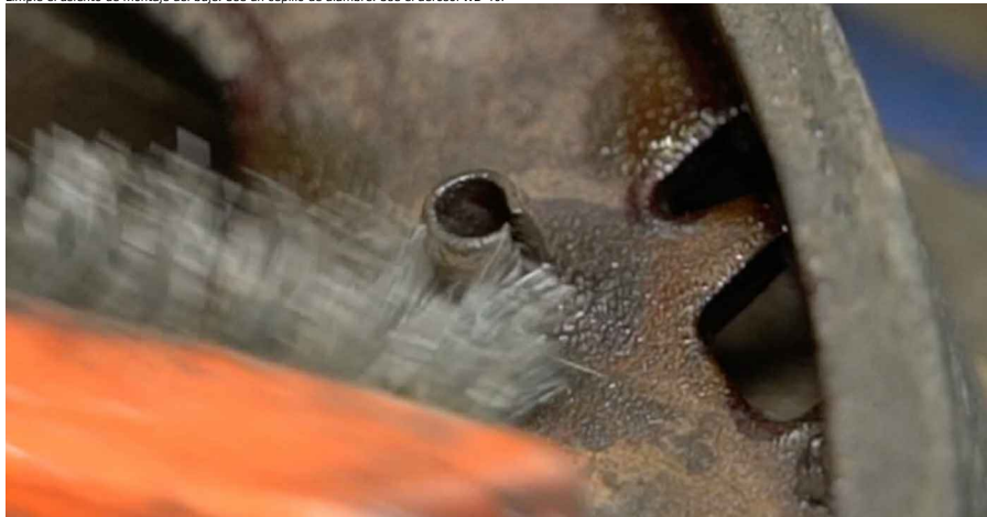
30 Retire el buje. Use alicates de bomba de agua.
