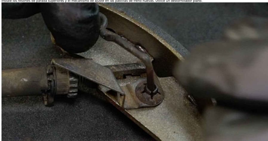
club.autodoc.es 11-18 36 Instale una zapata de freno derecha nueva.
