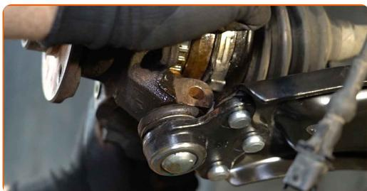
**52** Instale el perno de sujeción.
