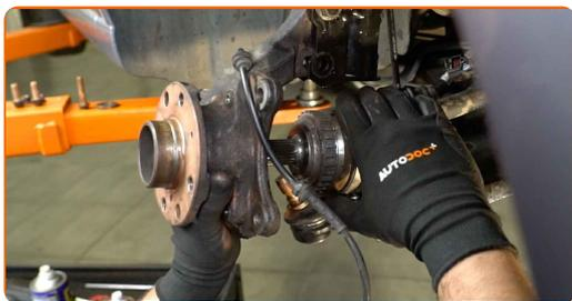
**51** Conecte la palanca inferior al muñón de dirección.
