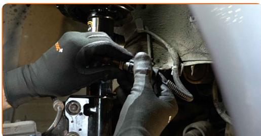
**70** Conecte los cables del captador ABS.
