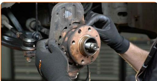
**62** Atornille las sujeciones de la cubierta del disco de freno. Utilice Torx T30.
