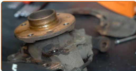
**34** Saque el cubo de rueda del muñón de dirección. Utilice un juego de cubos y rodamientos.
