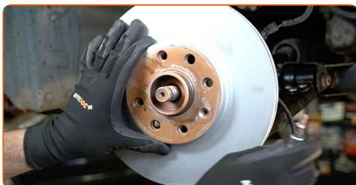
**65** Apriete la fijación del disco de freno. Utilice Torx T30. Utilice una llave dinamométrica. Apriételo a un par de 8 Nm.
