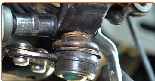
**54** Apriete la fijación del soporte esférico. Use una llave mixta del n.º 16. Use un vaso de impacto del n.º 16. Utilice una llave dinamométrica. Apriételo a un par de 55 Nm.
