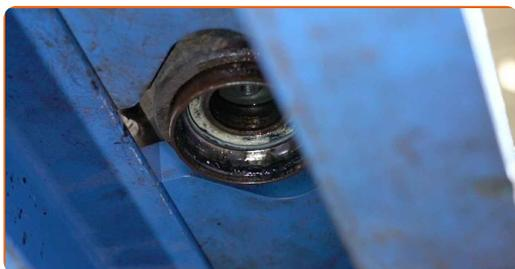
**39** Limpie el asiento de montaje del cojinete del cubo (buje). Use un cepillo de alambre. Use el aerosol WD-40.
