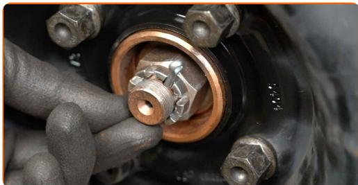
**79** Trate la sujeción del eje CV. Use grasa de cobre.
