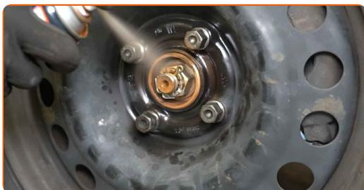
**80** Apriete los pernos de la rueda usando un patrón entrecruzado. Utilice una llave dinamométrica. Apriételo a un par de 110 Nm.
