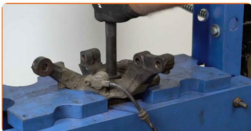
**35** Limpie las sujeciones del rodamiento del cubo de rueda. Use un cepillo de alambre. Use el aerosol WD-40.
