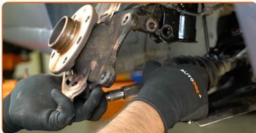
**29** Retire el perno de sujeción.
