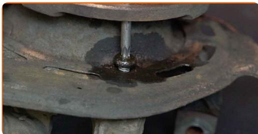
**33** Retire la cubierta del disco de freno.
