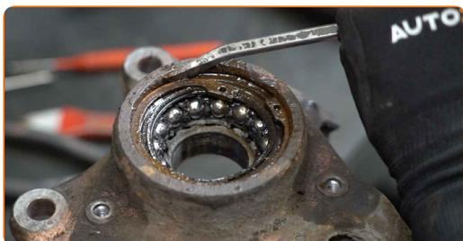
**37** Limpie el asiento de montaje del cojinete del cubo (buje). Use un cepillo de alambre. Use el aerosol WD-40.
