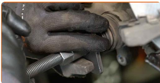
**16** Trate las pastillas de freno en el área donde su superficie entra en contacto con el soporte de la pinza de freno. Use pasta antichirridos.
