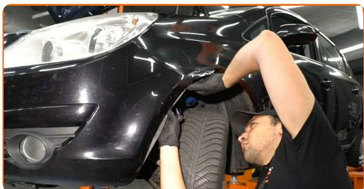
7 Desatornille las sujeciones inferiores del parachoques. Utilice Torx T25. Utilice una llave de trinquete.
