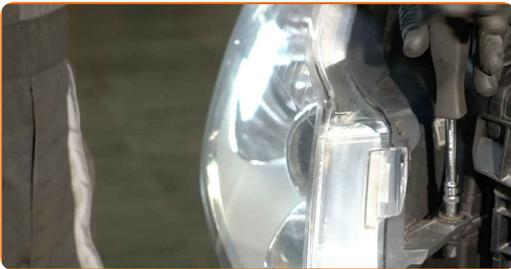
Sustitución: faros delanteros - OPEL Corsa D Van (S07). AUTODOC recomienda:
