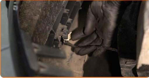
14 Desatornille las sujeciones del faro delantero. Use un vaso de impacto del n.º 8. Utilice una llave de trinquete.
