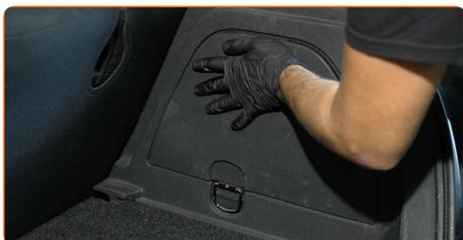
**19** Instale los clips del revestimiento de la parte lateral del maletero.
