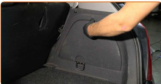
4 Separe el revestimiento de la parte lateral del maletero.
