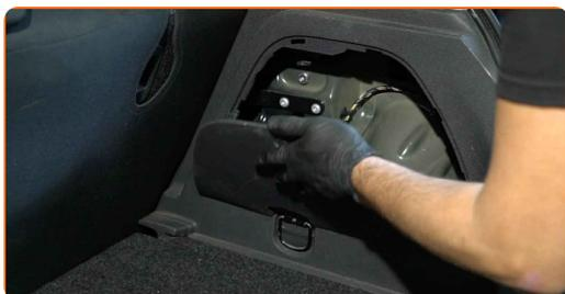
**18** Sujete el revestimiento de la parte lateral del maletero.
