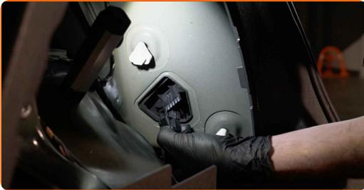
7 Desenrosque las sujeciones que conectan la luz trasera con la carrocería del coche.
