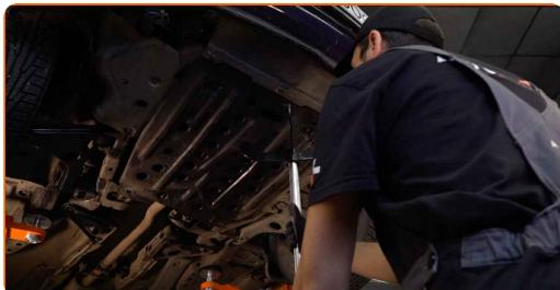
**5** Afloje y deshaga las sujeciones de la cubierta inferior del cárter de aceite. Use un vaso de impacto del n.º 12.
