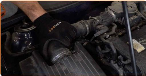
24 Fije la abrazadera en el manguito de admisión de aire. Use un vaso de impacto del n.º 7. Utilice una llave de trinquete.
