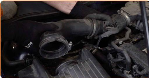
23 Conecte el tubo de entrada de aire a la carcasa del filtro de aire.
