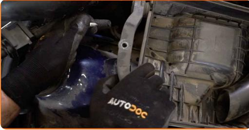
**11** Desconecte el portalámparas girándolo unos ~ 30 °. Retire el portalámparas del asiento de montaje del faro delantero.
