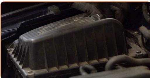
21 Conecte las sujeciones que conectan el tubo de aire y el arnés del cableado a la carcasa del filtro de aire.
