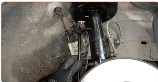
**13** Apriete las fijaciones de la bieleta de la barra estabilizadora. Usa una llave mixta del n.º 18.
