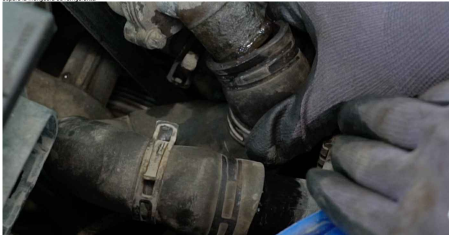
Sustitución: termostato refrigerante - OPEL KADETT B Ranchera familiar. AUTODOC recomienda: • ¡Cuidado! El refrigerante podría fugarse de las líneas de refrigerante y de la carcasa del termostato.
