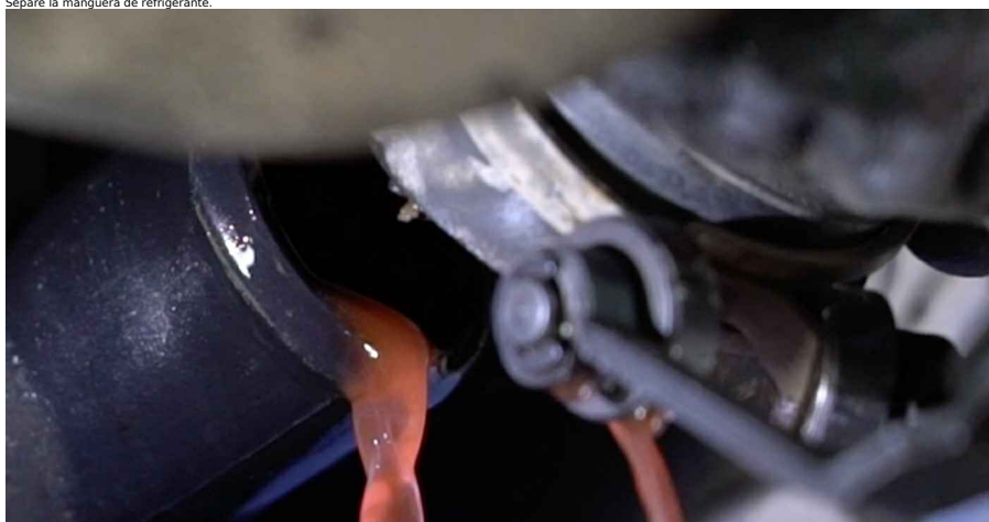
8 Separe la manguera de refrigerante.
