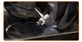
Instale los retenedores de las sujeciones de los tubos del filtro de combustible.
