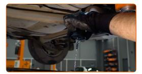
Retire los retenedores de las sujeciones de los tubos del filtro de combustible.
