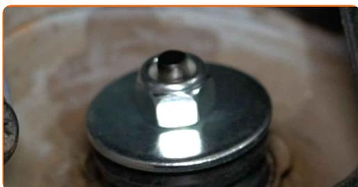
**28** Apriete la fijación inferior del amortiguador. Use un vaso de impacto del n.º 17. Utilice una llave dinamométrica. Apriételo a un par de 65 Nm.
