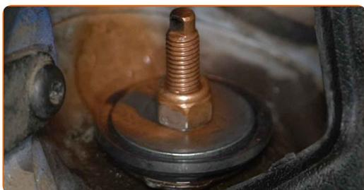
**39** Instale la tapa de protección del soporte del amortiguador.
