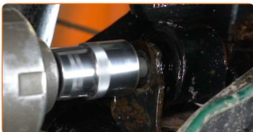
**16** Destornille la fijación superior del amortiguador.
