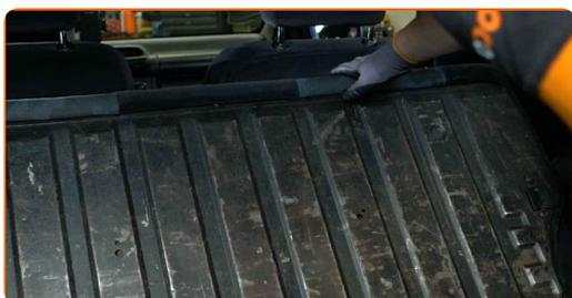
**4** Retire la cubierta del revestimiento de la parte lateral del maletero.
