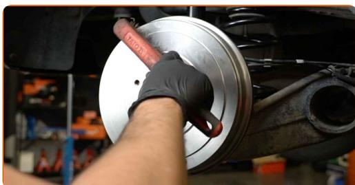
**22** Trate la superficie en la cual la llanta de la rueda entra en contacto con el tambor del freno. Use grasa de cobre.
