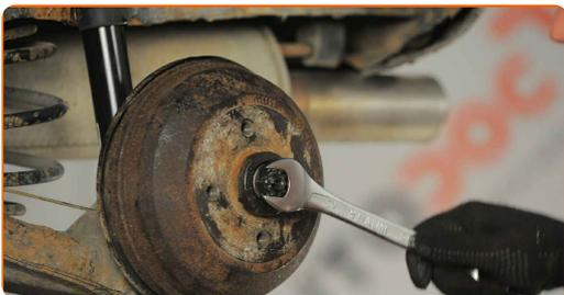
**24** Instale la chaveta de la tuerca de fijación del cojinete del cubo. Use alicates de punta redondeada.
