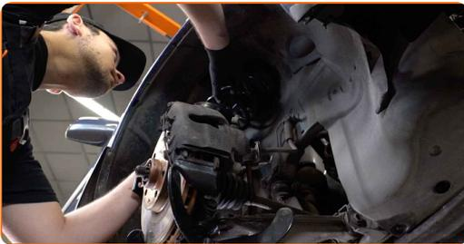
30 Fije la tuerca de fijación superior en la pata amortiguadora. No lo apriete.
