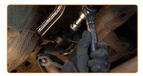
Apriete la sujeción delantera que conecta el brazo de control al subchasis. Use un vaso de impacto del n.º 18. Utilice una llave dinamométrica. Apriételo a un par de 100 Nm.
