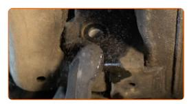
Suelte la sujeción que conecta la rótula del brazo de control con la mangueta de dirección. Utilice un cincel de metal plano. Utilice un martillo.
