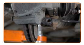
Retire la sujeción delantera del brazo de control.
