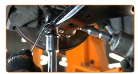
Atornille la fijación delantera de la palanca. Usa una llave mixta del n.º 18. Use un vaso de impacto del n.º 18. Utilice una llave giramachos.
