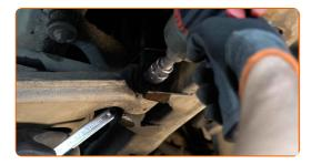
Desatornille la sujeción trasera que conecta el brazo de control al subchasis. Usa una llave mixta del n.º 18 (2 piezas).
