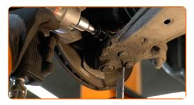
Retire el perno de sujeción.
