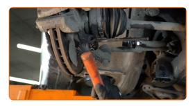
Instale el brazo nuevo. Utilice un mazo de goma. Use una palanca.
