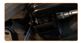
Apriete el tornillo de sujeción trasero que conecta el brazo al subchasis del automóvil. Use un vaso de impacto del n.º 18. Utilice una llave dinamométrica. Apriételo a un par de 100 Nm.
