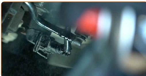
**4** Separe el conector del sensor de posición del árbol de levas.
