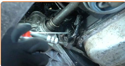
**3** Separe el conector del sensor de posición del cigüeñal. Utilice una palanca de montaje.
