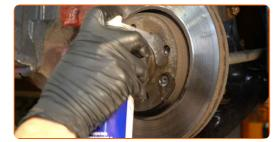
Destornille la fijación del disco de freno. Utilice Torx T30. Utilice un destornillador de impacto.
