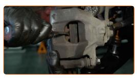
Destornille la fijación del cáliper de freno. Use un vaso de impacto del n.º 13. Utilice una llave de trinquete.
