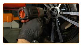
Baje el automóvil y, manteniendo el orden cruzado, apriete los pernos de fijación de las ruedas. Utilice una llave de impacto para llanta # 17. Utilice una llave dinamométrica. Apriételo a un par de 100 Nm.
