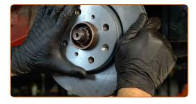
Apriete la fijación del disco de freno. Utilice Torx T30. Utilice una llave dinamométrica. Apriételo a un par de 5 Nm.
