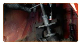
Establezcan el soporte de freno y lo fijen. Use un vaso de impacto del n.º 13. Utilice una llave dinamométrica. Apriételo a un par de 30 Nm.
