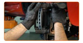
Apriete la fijación de la pinza del cáliper de freno. Use un vaso de impacto del n.º 17. Utilice una llave dinamométrica. Apriételo a un par de 89 Nm.
