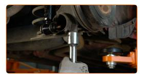
Atornille la sujecion inferior del amortiguador. Use un vaso de impacto del n.º 14.
