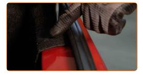
Desenrosque la sujeción del revestimiento de la parte lateral del maletero. Utilice un destornillador Phillips.
