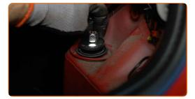
Apriete la fijación inferior del amortiguador. Use un vaso de impacto del n.º 14. Utilice una llave dinamométrica. Apriételo a un par de 48 Nm.
