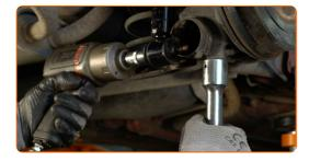
Atornille la sujeción superior del amortiguador.
