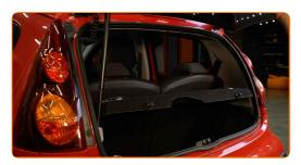
Retire los clips de sujeción del revestimiento de la parte lateral del maletero. Utilice una herramienta de extracción de clips.
