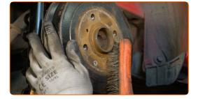
Trate la superficie en la cual la llanta de la rueda entra en contacto con el tambor del freno. Use grasa de cobre.
