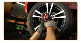
Baje el automóvil y, manteniendo el orden cruzado, apriete los pernos de fijación de las ruedas. Utilice una llave de impacto para llanta # 17. Utilice una llave dinamométrica. Apriételo a un par de 100 Nm.
