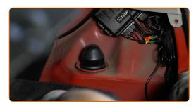
Destornille la fijación superior del amortiguador. Usa una llave mixta del n.º 14 (2 piezas).
