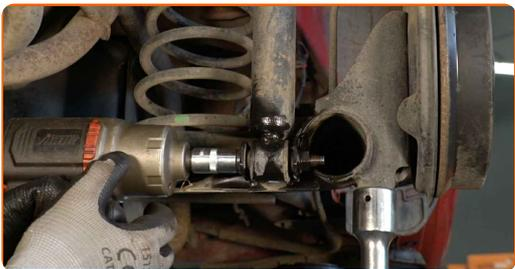
**9** Retire el perno de sujeción.
