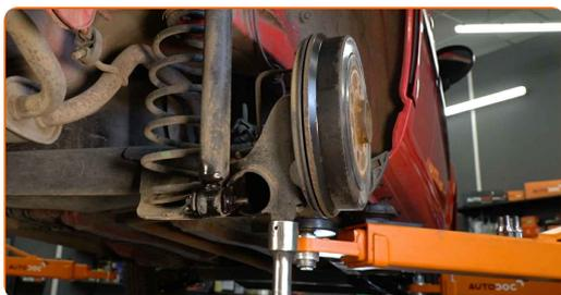
**8** Destornille la fijación inferior del amortizador. Use un vaso de impacto del n.º 14. Utilice una llave de trinquete.
