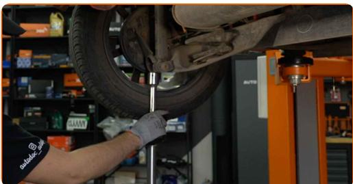
**12** Destornille la fijación inferior del amortizador. Use un vaso de impacto del n.º 14. Utilice una llave de trinquete.
