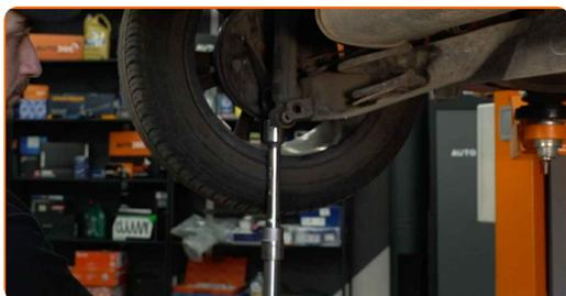
**14** Retire el soporte por debajo de la viga trasera.
