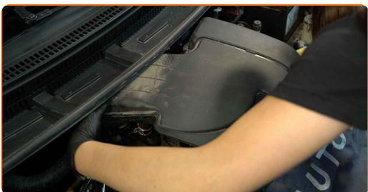
**24** Presione los clips de la cubierta del filtro de aire en su lugar.
