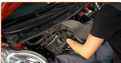
**6** Cubra el cuerpo del acelerador con una toalla de microfibra para evitar que el polvo y la suciedad penetren en el sistema.
