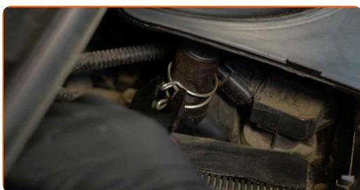
**4** Suelte los clips de la cubierta del filtro de aire.
