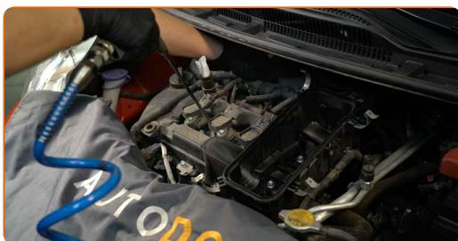
**8** Desconecte los conectores de las bobinas del encendido.
