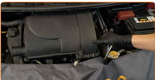
**25** Instale las abrazaderas de sujeción del tubo del respiradero del filtro de aire y del tubo de admisión del filtro de aire. Utilice alicates para abrazaderas clic-R.
