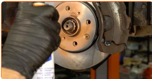
**28** Limpie el asiento de montaje de la llanta de la rueda. Use un limpiador de frenos.
