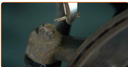
**7** Limpie las sujeciones que conectan el extremo de la barra de acoplamiento con la mangueta de dirección. Use un cepillo de alambre. Use el aerosol WD-40.
