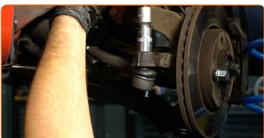
**17** Stram møtrikken der forbinder styrekuglen og styrespindlen. Usa una llave mixta del n.º 17. Usa una llave mixta del n.º 19.
