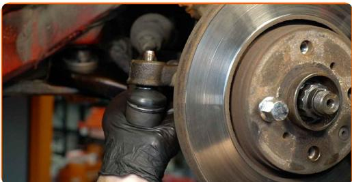
**16** Atornille la tuerca de sujeción que conecta el extremo de la barra de acoplamiento a la mangueta de dirección. Use un vaso de impacto del n.º 19. Utilice una llave de trinquete.
