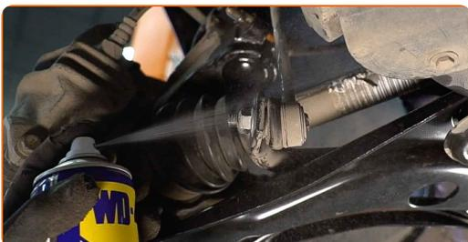
**7** Afloje los sujeciones que conectan la bieleta de barra estabilizadora. Use un vaso de impacto del n.º 16.
