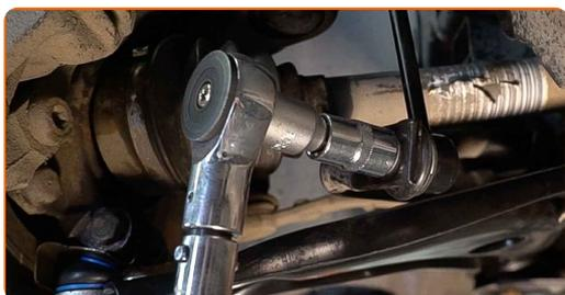
**12** Apriete la sujeción que conecta la bieleta de barra estabilizadora al amortiguador. Use un vaso de impacto del n.º 16. Utilice una llave dinamométrica. Apriételo a un par de 43 Nm.
