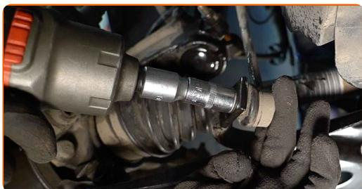
**8** Desatornille la sujeción que conecta la bieleta de barra estabilizadora al amortiguador. Use un vaso de impacto del n.º 16.
