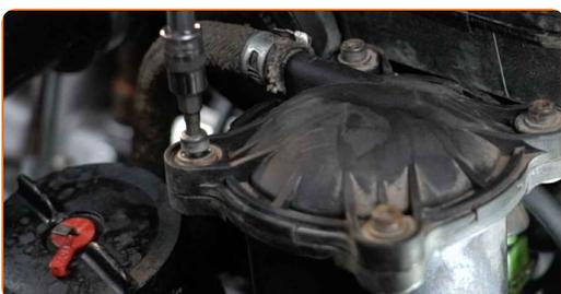
**5** Retire la cubierta de la carcasa del filtro de combustible.
