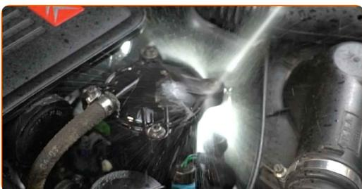
**4** Desenrosque las sujeciones de la cubierta del filtro de combustible. Use Vaso HEX No. H4. Utilice una llave de trinquete.
