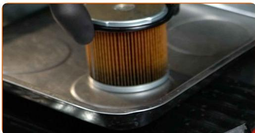
**8** Bombee el combustible fuera de la carcasa del filtro de combustible. Utilice una jeringa de fluidos de accionamiento manual.
