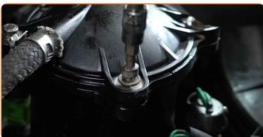
**12** Limpie la carcasa del filtro de combustible y la cubierta. Utilice un spray de limpieza multiuso.
