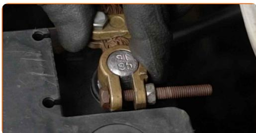
**26** Enrosque la sujeción del borne negativo de la batería. Usa una llave mixta del n.º 10.
