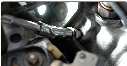
**11** Retire las tuercas de sujeción. Utilice un imán telescópico.
