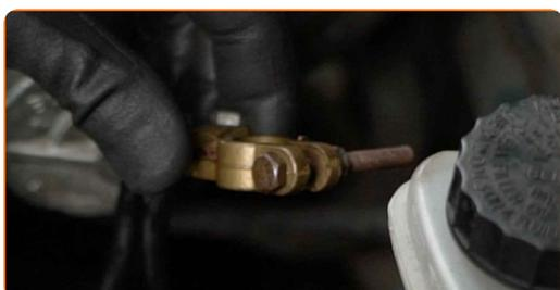
**7** Afloje las abrazaderas de la manguera de aire. Use un vaso de impacto del n.º 7. Utilice una llave de trinquete.
