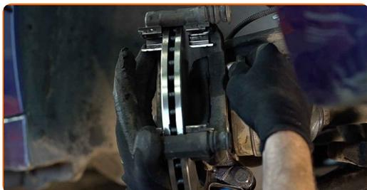
**25** Apriete la fijación de la pinza del cáliper de freno. Utilice Torx T55. Utilice una llave dinamométrica. Apriételo a un par de 105 Nm.
