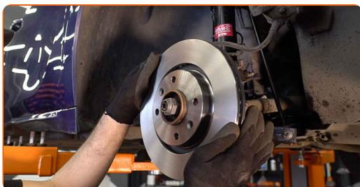
**22** Apriete la fijación del disco de freno. Utilice Torx T30. Utilice una llave dinamométrica. Apriételo a un par de 9 Nm.
