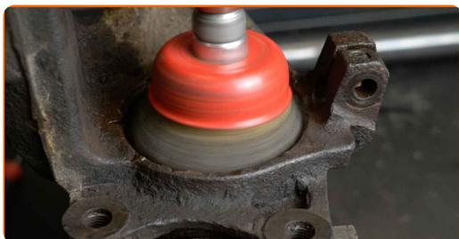
**48** Inserte presionando el rodamiento nuevo en el muñón de dirección. Juego de cubos y rodamientos.
