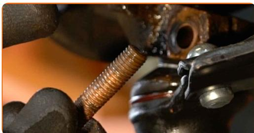
**29** Limpie las sujeciones que conectan el extremo de la barra de acoplamiento con la mangueta de dirección. Use un cepillo de alambre. Use el aerosol WD-40.
