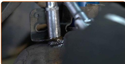
**22** Retire el soporte del latiguillo de freno.
