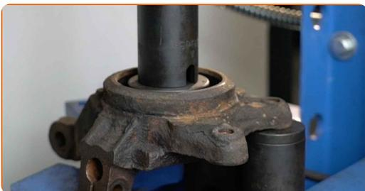
**47** Limpie el asiento de montaje del cojinete del cubo (bujete). Use un cepillo de alambre. Use el aerosol WD-40.
