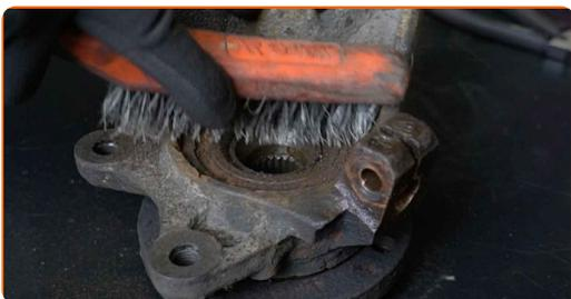
**43** Retire el cubo de rueda de la mangueta de dirección. Juego de cubos y rodamientos.
