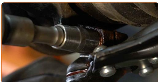
**28** Retire el perno de sujeción.
