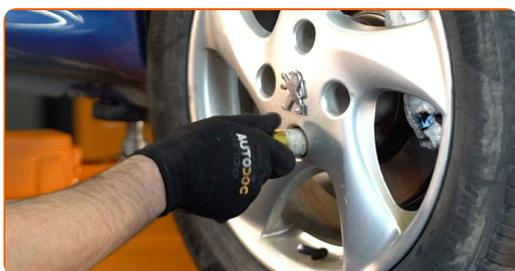
**31** Baje el automóvil y, manteniendo el orden cruzado, apriete los pernos de fijación de las ruedas. Utilice una llave dinamométrica. Apriételo a un par de 100 Nm.
