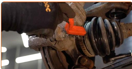
**9** Destornille la fijación del cáliper de freno. Use un vaso de impacto del n.º 13. Utilice una llave de trinquete.
