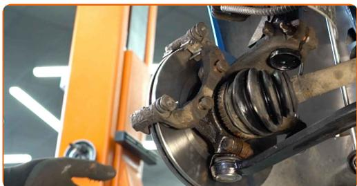
**22** Apriete la fijación de la pinza del cáliper de freno. Use un vaso de impacto del n.º 19. Utilice una llave dinamométrica. Apriételo a un par de 105 Nm.
