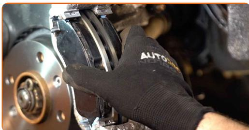
**26** Establezcan el soporte de freno y lo fijen. Use un vaso de impacto del n.º 13. Utilice una llave dinamométrica. Apriételo a un par de 30 Nm.
