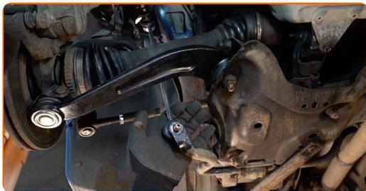
**11** Apriete la sujeción que conecta la bieleta de barra estabilizadora al amortiguador. Usa una llave mixta del n.º 17. Utilice Torx T30. Utilice una llave dinamométrica. Apriételo a un par de 35 Nm.
