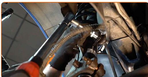
**12** Apriete la sujeción que conecta la bieleta a la barra estabilizadora. Usa una llave mixta del n.º 17. Utilice Torx T30. Utilice una llave dinamométrica. Apriételo a un par de 35 Nm.
