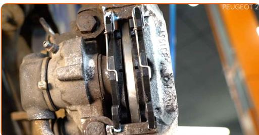
**17** Trate la superficie donde el disco del freno entra en contacto con la llanta de la rueda. Use grasa de cobre.
