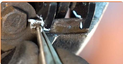
**16** Instale los muelles de retención de las pastillas de freno.
