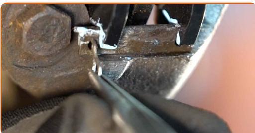
**34** Trate la superficie donde el disco del freno entra en contacto con la llanta de la rueda. Use grasa de cobre.
