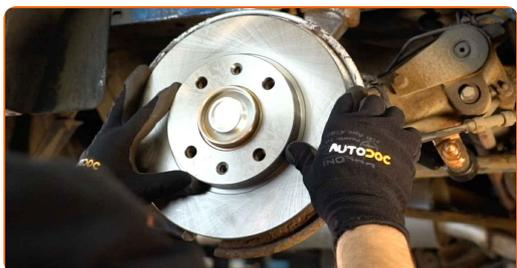
**28** Apriete la fijación del disco de freno. Utilice Torx T30. Utilice una llave dinamométrica. Apriételo a un par de 9 Nm.
