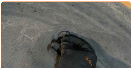
**29** Trate las sujeciones del amortiguador. Use grasa de cobre.
