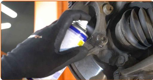
**13** Destornille la fijación de la pinza del cáliper de freno. Utilice Torx T55. Utilice una llave giramachos. Utilice una llave de trinquete.
