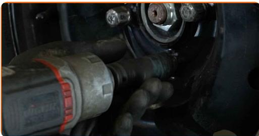
**26** Baje el automóvil y, manteniendo el orden cruzado, apriete los pernos de fijación de las ruedas. Utilice una llave de impacto para llanta # 19. Utilice una llave dinamométrica. Apriételo a un par de 90 Nm.
