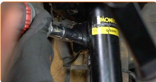
11 Retire el enlace estabilizador de estabilidad transversal.
