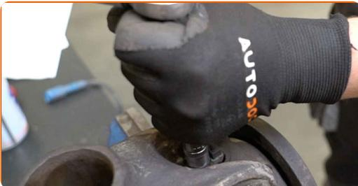
**54** Trate el asiento de montaje del puntal amortiguador en la mangueta de dirección. Use un cepillo de alambre. Use el aerosol WD-40.
