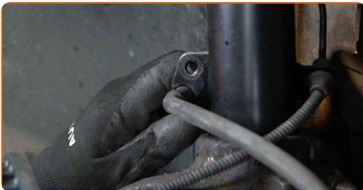
**82** Atornille la fijación del soporte del latiguillo de freno a la pata amortiguadora. Use un vaso de impacto del n.º 13. Utilice una llave dinamométrica. Apriételo a un par de 10 Nm.
