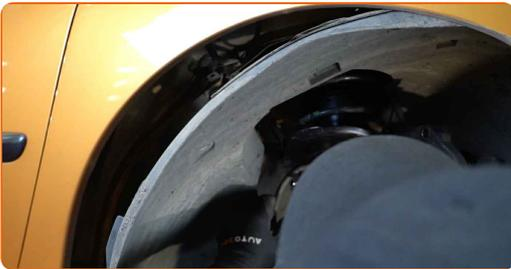
69 Vuelva a instalar los clips de plástico del revestimiento del paso de rueda.
