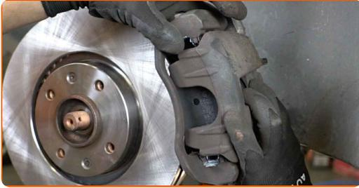
**80** Apriete la fijación de la pinza del cáliper de freno. Utilice Torx T55. Utilice una llave dinamométrica. Apriételo a un par de 105 Nm.
