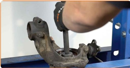
**44** Quite la guadera de cojinete interior del cubo. Utilice un juego de cubos y rodamientos. Utilice un separador de rodamientos.
