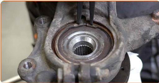
**42** Suelte el tornillo de banco y retire la mangueta de dirección ensamblada con el cubo de rueda.
