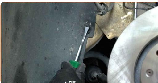
21 Retire la cubierta del paso de rueda.
