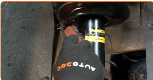
10 Desatornille la sujeción que conecta la bieleta de barra estabilizadora al amortiguador. Use un vaso de impacto del n.º 17. Utilice una llave de trinquete.
