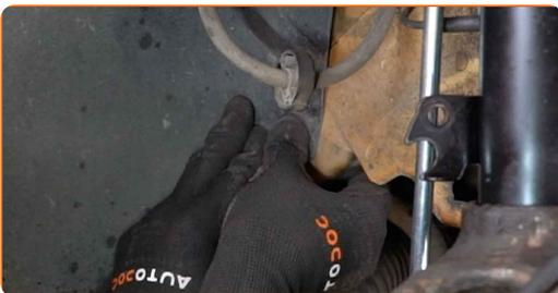
70 Limpie los asientos de montaje del extremo de la barra de acoplamiento. Use un cepillo de alambre. Use el aerosol WD-40.
