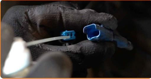
67 Conecte el conector del sensor ABS.
