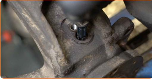
**53** Apriete la sujeción que conecta el sensor ABS con la mangueta de dirección. Use un vaso de impacto del n.º 13. Utilice una llave dinamométrica. Apriételo a un par de 10 Nm.
