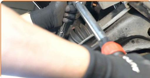
**81** Fije el soporte de fijación del latiguillo de freno.
