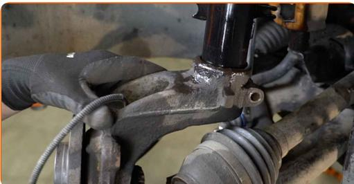
**56** Fije la pata amortiguadora en el muñón de dirección.
