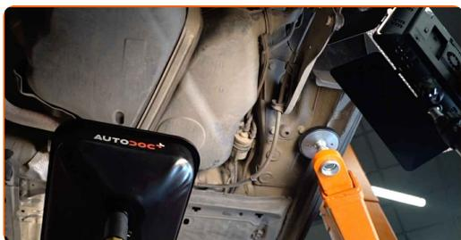
**8** Destornille el tapón de desagüe. Usa una llave mixta del n.º 22.
