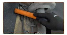
Desatornille la sujeción que conecta la bieleta de barra estabilizadora al amortiguador. Usa una llave mixta del n.º 16. Utilice Torx T30. Utilice una llave de trinquete.
