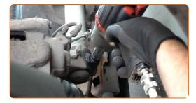
Retire el perno de sujeción.
