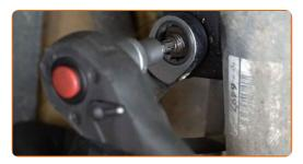
Retire el enlace estabilizador de estabilidad transversal.
