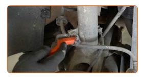
Destornille la fijación del soporte del latiguillo de freno de la pata amortiguadora. Usa una llave mixta del n.º 13.
