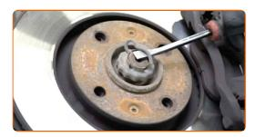
Limpie el tornillo de sujeción del eje de transmisión. Use un cepillo de alambre. Use el aerosol WD-40.
