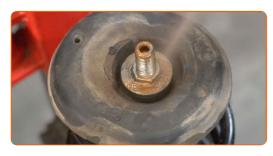
Retire el puntal amortiguador que está montado.
