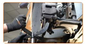
Separe el eje de transmisión de la mangueta de dirección. Use un punzón. Utilice un martillo.
