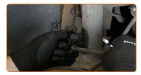
Desconecte el cableado del captador ABS. Use una palanca.
