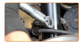
72 Conecte los cables del captador ABS.
