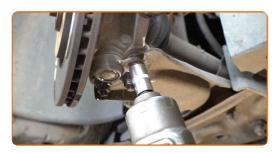
Desconecte el soporte esférico del brazo. Use una palanca.
