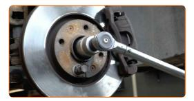
Instale el pasador de chaveta de la tuerca del eje CV. Use una palanca.
