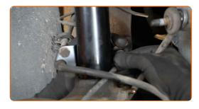
73 Instale la barra del estabilizador de estabilidad transversal.
