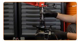
Instale el guardapolvo y el tope en el amortiguador nuevo.
