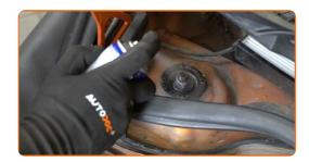
Afloje la sujeción superior del soporte del amortiguador. Usa una llave mixta del n.º 21. Use Vaso HEX No. H7. Utilice una llave de trinquete.
