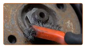
Afloje la sujeción del eje de transmisión. Use un vaso de impacto del n.º 35. Utilice una llave giramachos.
