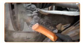
Desatornille la sujeción inferior que conecta el puntal amortiguador a la mangueta de dirección. Use un vaso de impacto del n.º 16. Utilice una llave de trinquete.
