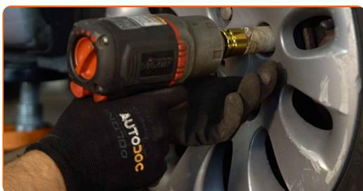
**32** Baje el automóvil y, manteniendo el orden cruzado, apriete los pernos de fijación de las ruedas. Utilice una llave dinamométrica. Apriételo a un par de 100 Nm.
