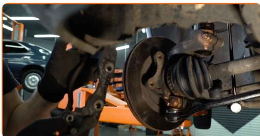
**15** Limpie las sujeciones del disco de freno. Use un cepillo de alambre. Use el aerosol WD-40.
