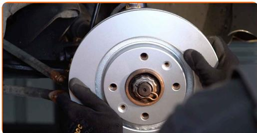
**20** Apriete la fijación del disco de freno. Utilice un destornillador Phillips. Utilice una llave dinamométrica. Apriételo a un par de 9 Nm.
