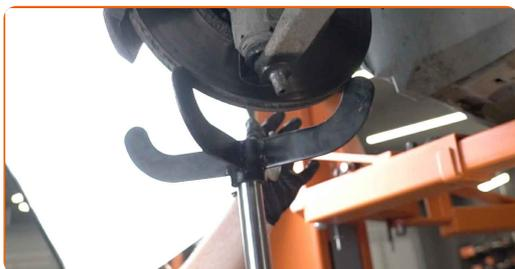
**14** Desconecte la bisagra esférica del brazo. Use una palanca.
