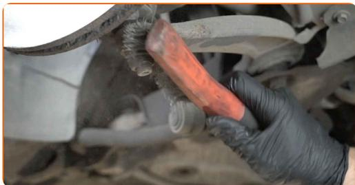
**11** Desenrosque la fijación que conecta la rótula al brazo de control de la suspensión. Use un vaso de impacto del n.º 21. Utilice una llave giramachos.
