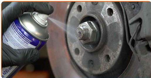
**9** Afloje la sujeción del eje de transmisión. Use un vaso de impacto del n.º 36. Utilice una llave de trinquete.
