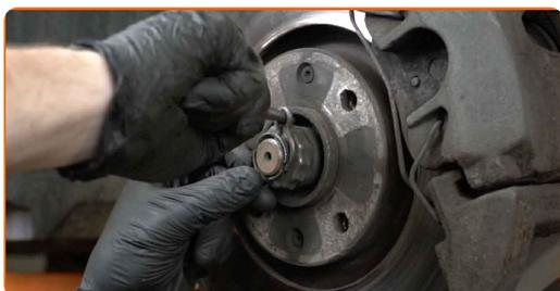
**8** Limpie el tornillo de sujeción del eje de transmisión. Use un cepillo de alambre. Use el aerosol WD-40.
