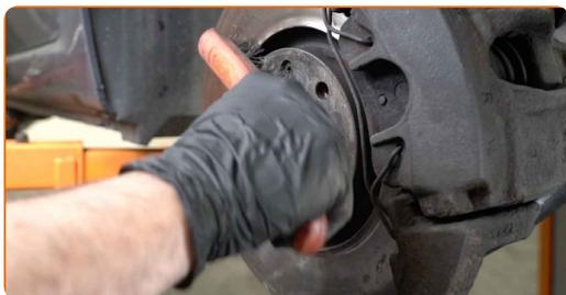
**47** Trate la superficie donde el disco del freno entra en contacto con la llanta de la rueda. Use grasa de cobre.
