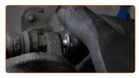
Apriete las sujeciones de la pinza del freno. Usa una llave mixta del n.º 13. Usa una llave mixta del n.º 15. Utilice una llave dinamométrica. Apriételo a un par de 27 Nm.
