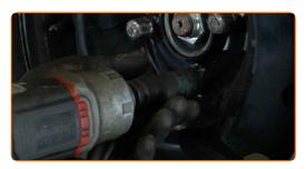
Baje el automóvil y, manteniendo el orden cruzado, apriete los pernos de fijación de las ruedas. Utilice una llave de impacto para llanta # 19. Utilice una llave dinamométrica. Apriételo a un par de 90 Nm.
