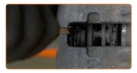
Desenrosque las sujeciones de la pinza de freno. Usa una llave mixta del n.º 13. Usa una llave mixta del n.º 15.
